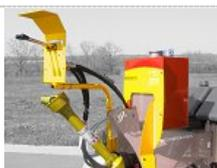
2 ° motore idraulico per trasportatore con portata > 60 L / min
