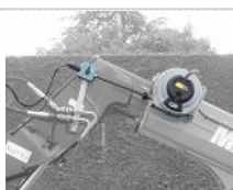
Bobina elettrica con cavo lungo 15 m e pulsante in cabina e presa accendisigari 12 V
