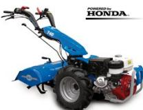
**Motokltivator 740** ima menjac sa 3 brzine napred - 3 brzine nazad i brzi invertor za promenu smera voznje, sto mu omogucava da radi sa širokim opsegom brzina kretanja tako da mogu da se prilagode razlicitim potrebama. Ima diferencijal sa blokiračem. Upravljačke ručke su podesive i okretne tako da sa lakoćom koristi kako prednje tako i zadnje priključne uredjaje. Doboš kočnice sa nezavisnom kontrolom na oba točka.
