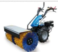
**ČIŠĆENJE:** sa usmeravajućom četkom sa posebnim vlaknima, koja omogućava primenu pored opšteg čišćenja i za odstranjivanje snega.
