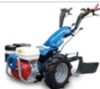
**PLUG I ZAGRTAČ:** dizajnirani i prilagođeni motokultivatorima, omogućavajući razumno korišćenje i pripremu zemljišta, za pravljenje brazdi za setvu ili navodnjavanje.
