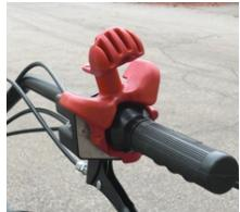
**730 PowerSafe EasyDrive** koristi novo patentirani hidraulično-mehanički invertor za brzu promenu smera vožnje napred - nazad, bez potrebe za kvačilom i menjanjem brzina već jednostavnim aktiviranjem kontrole **EasyDrive**.
