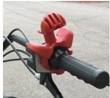
630 WS EasyDrive, pored ekskluzivne kontrole kvačilom, imaju novi patentirani **hidraulično Mehanički Invertor**, novi uređaj koji omogućava brzu promenu smera vožnje napred i nazad, bez potrebe za kavčilom i menjanja brzina već jednostavnim aktiviranjem odgovarajuće **kontrole EasyDrive**.
