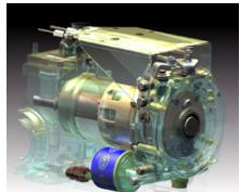
Hidraulično kvačilo u uljnom ® kućištu PowerSafe omogućava svakome da pristupi korišćenju WS-630 HD u potpunoj sigurnosti, koristeći efekte savremene tehnologije koja se koristi u peoizvodnji savremenih automobila.
