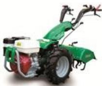
**FREZA:** je osnovni alat, otporan i pouzdan, ne zahteva redovno održavanje. Dostupan u različitim dimenzijama, u zavisnosti od snage mašine za koju će biti priključen.
